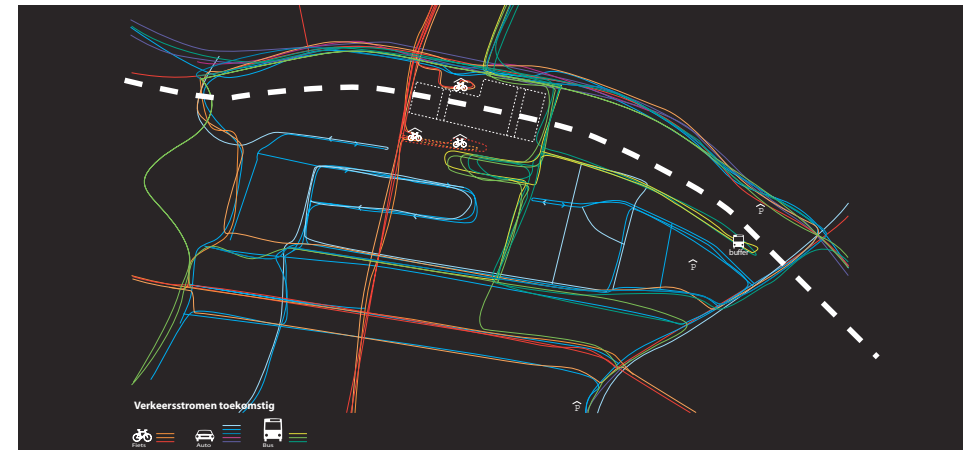
Ontwarring van de verschillende verkeersmodaliteiten in het stationsgebied, BVR, 2004
